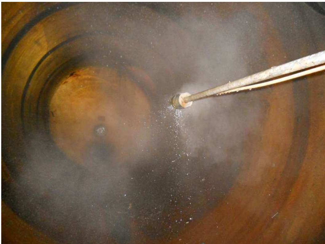
Interno camera deodorizzazione, flusso nebulizzato.
