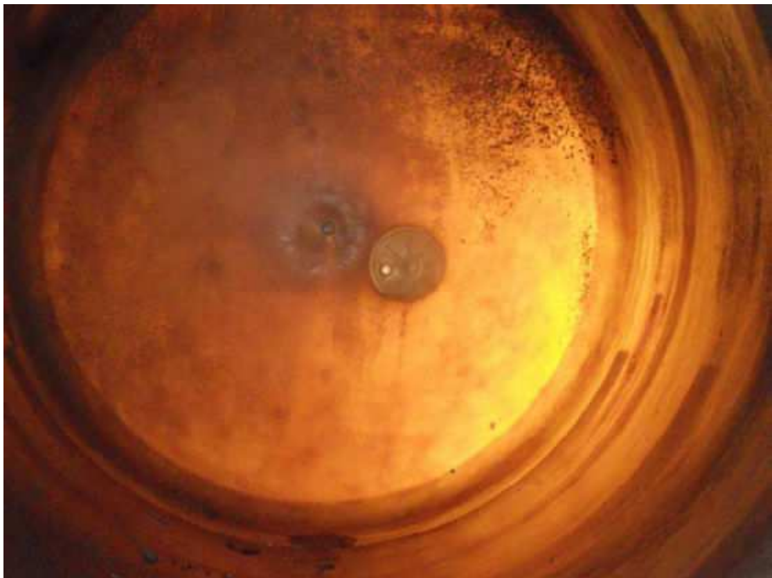
Interno camera deodorizzazione, flusso nebulizzato.
